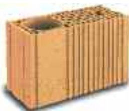
Poteau GF R20 R 450 x 200 x 299 mm - 19,7 kg réserve Ø 150 mm 50 pièces/palette - 3,3 pièces/ml
